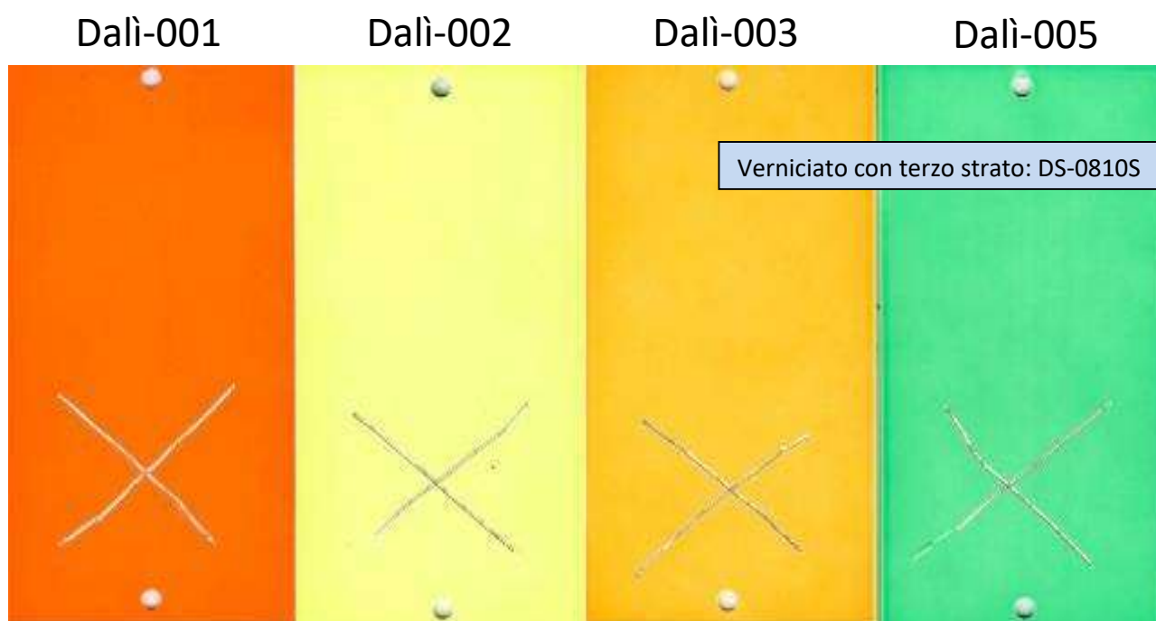
Figura 9: Confronto dei campioni dopo 1000 ore in umidostato
