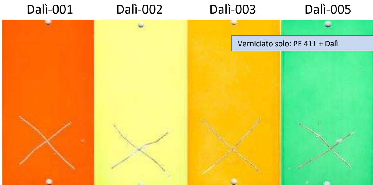
Figura 8: Confronto dei campioni dopo 1000 ore in umidostato
