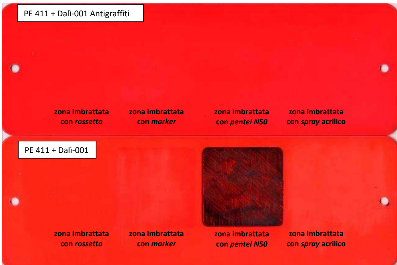
Figura 6: Test comparativo eseguito su lamierini verniciati con PE 411 + Dali-001 Antigrافitti e PE 411 + Dali-001
